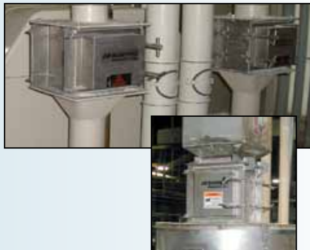
Пневматическая самоочистка магнита в виде корпуса из пластин
