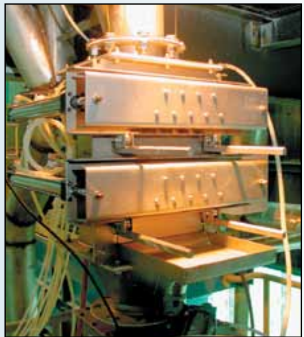
Выдвижной магнит серии HF с функцией пневматической самоочистки
