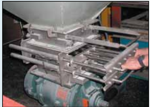
Выдвижной магнит серии HF с функцией ручной самоочистки
