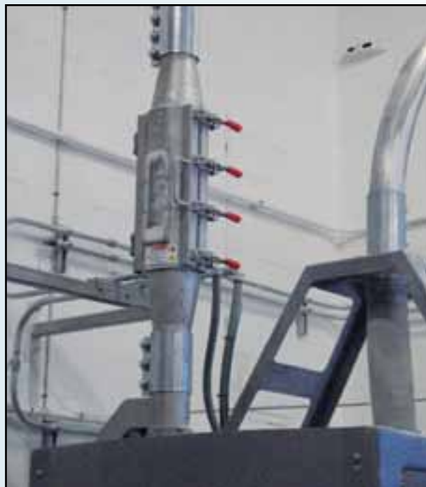
Показан вместе со смотровым окном, обеспечивающим хорошую видимость, которое поставляется по отдельному заказу
