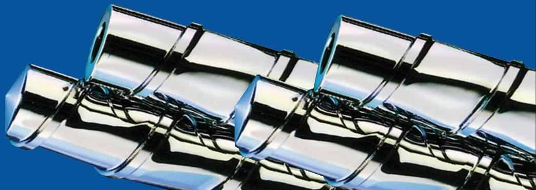
**Шнек Xaloy V-Mixer™** имеет запатентованную конструкцию «прокачиваемого» смешения, в котором создаются локализованные зоны высокого и низкого напряжения сдвига с низким перепадом давления. Его уникальная геометрия обеспечивает смешение в двух направлениях. При его вращении поток расплава выдавливается вверх и вниз, а также между витками (из стороны в сторону) одновременно. Регулируемая глубина канала меняет соотношение дисперсионного и дистрибутивного смешения.
